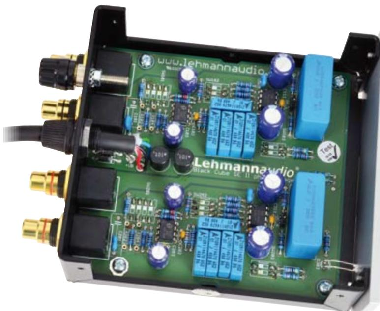
Norbert Lehmann setzt auf ein mit Präzisions-Polypropylen-Kondensatoren aufgebautes, passives RIAA-Netzwerk, das zwischen zwei linearen Verstärkerstufen angeordnet ist. Die maximale Verstärkung beträgt 66 dB. Der Black Cube sollte möglichst nahe am Tonarm positioniert werden; die Verbindungsleitung zum externen Netzteil ist abgeschirmt.
