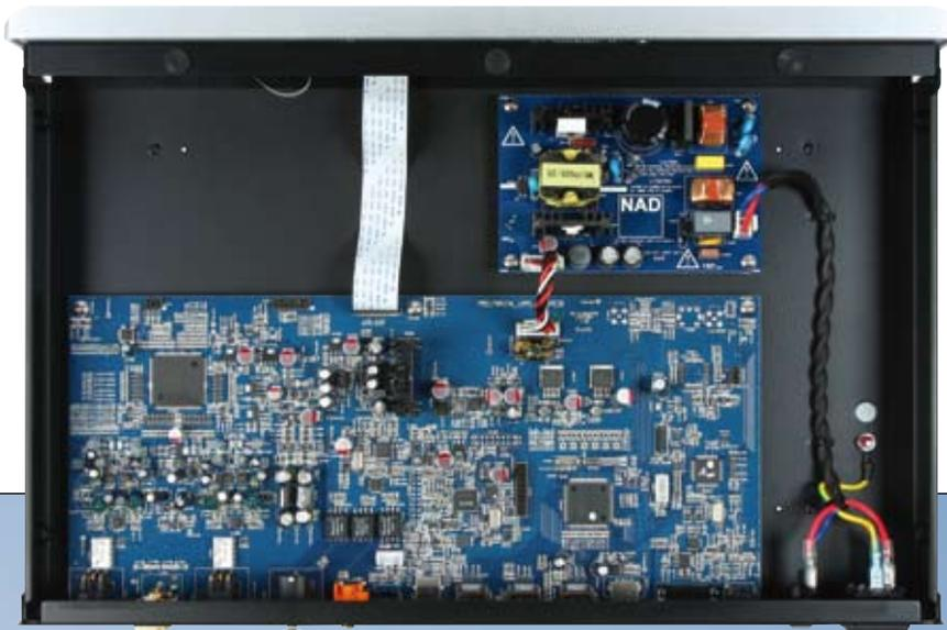
**HOCHLEISTUNGS-ICS:** Der große Chip rechts unten ist ein HDMI-Spezialist von Analog Devices, links auf dem Mainboard der Zetex-Chip. Für Strom sorgt ein Schaltnetzteil.
