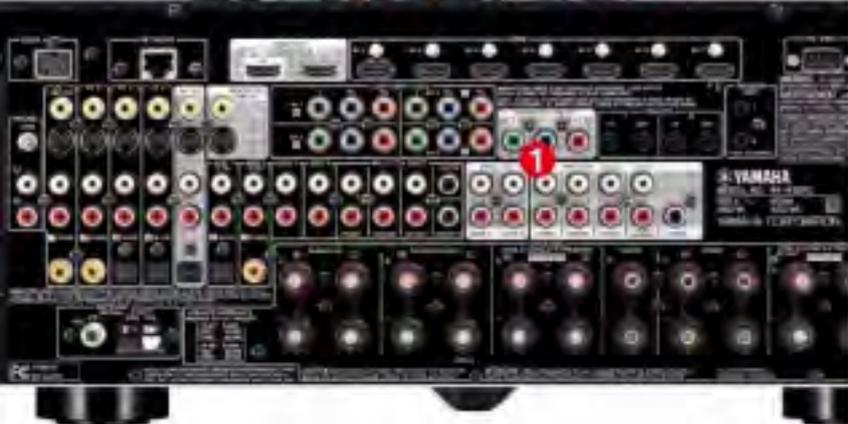
Großes Kino: Der RX A 3010 kann elf Hauptkanäle prozessieren und gibt sie bei Bedarf – teilweise oder allesamt – via Pre-Out (1) aus. Als Digitalboard (2) wird ein ähnliches Teil wie im RX A 2010 (10/11) verwendet.
