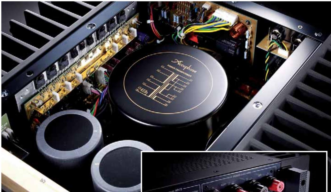
▲ Das satte Netzteil mit 600-Watt-Ringkerntrafo und zwei 47 000-Mikrofarad-Speicherkondensatoren stellt bei jeder Belastung eine stabile Grundlage dar.
