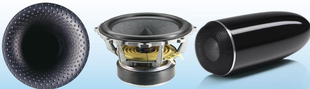
Das kennzeichnet B&W: Bassreflexrohre mit Golfball-ähnlicher Lochung für einen wirbelstromfreien Luftfluss, Tieftöner mit Kevlar-verstärkter Papiermembran und sehr kräftigem Antrieb und eine kompakte Alu-Kalotte mit Neodym-Magneten im strömungsgünstigen, aufgesetzten Metallgehäuse
