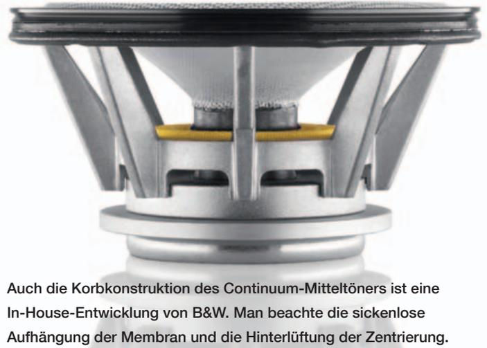
Auch die Korbkonstruktion des Continuum-Mitteltöners ist eine In-House-Entwicklung von B&W. Man beachte die sickenlose Aufhängung der Membran und die Hinterlüftung der Zentrierung.
