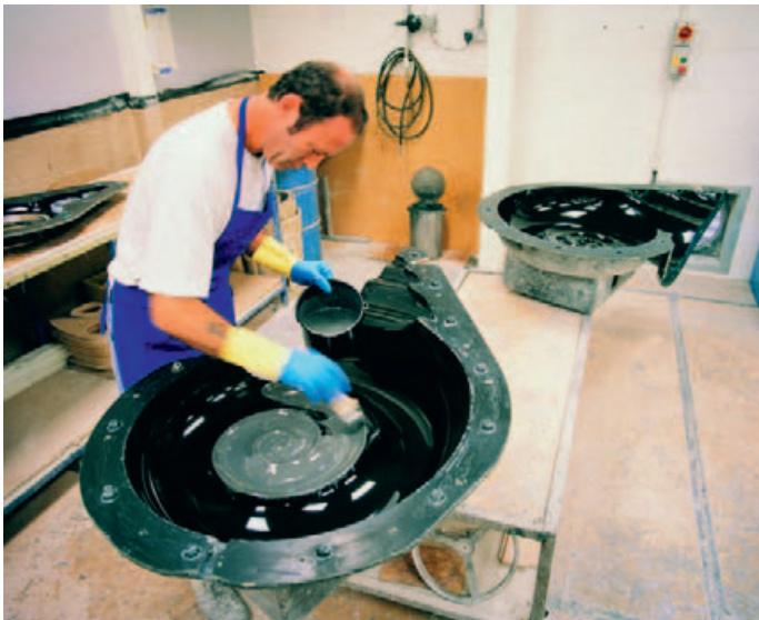
Beim Bau der Ur-Nautilus (rechts) Anfang der 1990er-Jahre wurden die Prototypenbauer an ihre Grenzen gebracht. Im Bild oben werden die Gussformen präpariert. Doch sowohl akustisch als auch optisch gelang das Projekt, die „Schnecke“ wurde zur Lautsprecherikone.
