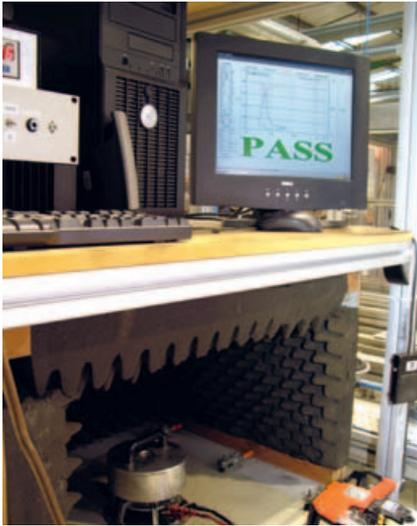
Bei B&W in Worthing wird auch in der Produktion gemessen – und zwar jedes einzelne Chassis, dass in einer kleinen Messkammer strengsten Toleranzen genügen muss. Nur, wenn der automatische Vergleich mit der Referenz das Ergebnis „PASS“ liefert, wird es in eine B&W eingebaut.
