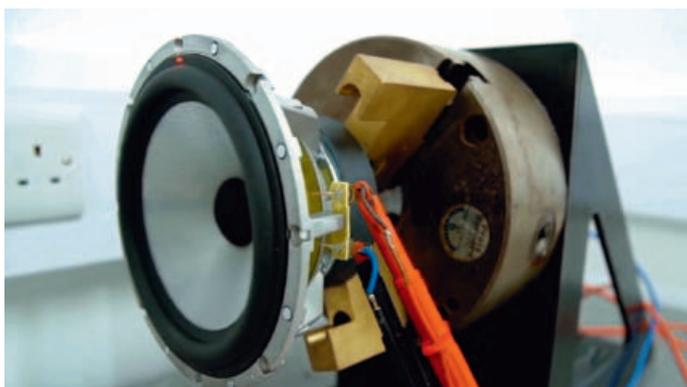
Der Härtestest für den neuen Mitteltöner mit Continuum-Membran: Die Klippel-Analyse per Laser-Interferometrie. Dabei wird das Chassis im freischwingenden Zustand mit Signalen erheblicher Leistung beschickt und die Bewegungen der Membran Punkt für Punkt mit einem Laser abgetastet.
