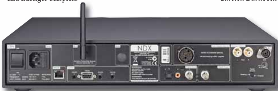
Neben den obligatorischen Netzwerk-Ein- (links) und Audio-Ausgängen (rechts) bietet der NDX auch drei Digitalanschlüsse (Mitte unten) und einen Stromanschluss für das externe Netzteil XPS (darüber)
