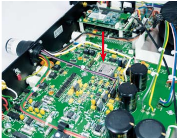
Die ausgefuchste Signalberechnung und die digitale Filterung erledigt beim NDX ein Sharc-Prozessor mit 40 Bit Genauigkeit.
