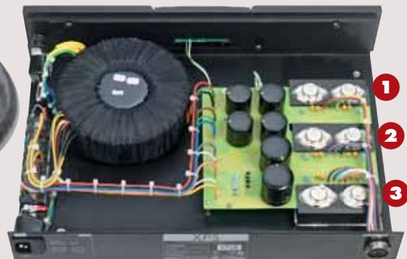
Im offenen Gehäuse kann man sehen, dass der wuchtige Ringkerntrafo eines XPS drei separate Netzaufteilungen (1, 2 und 3) versorgt, die zusammen sechs Stromkreise bilden. Übertragen wird die Spannung über das optionale Power-Line-Kabel.
