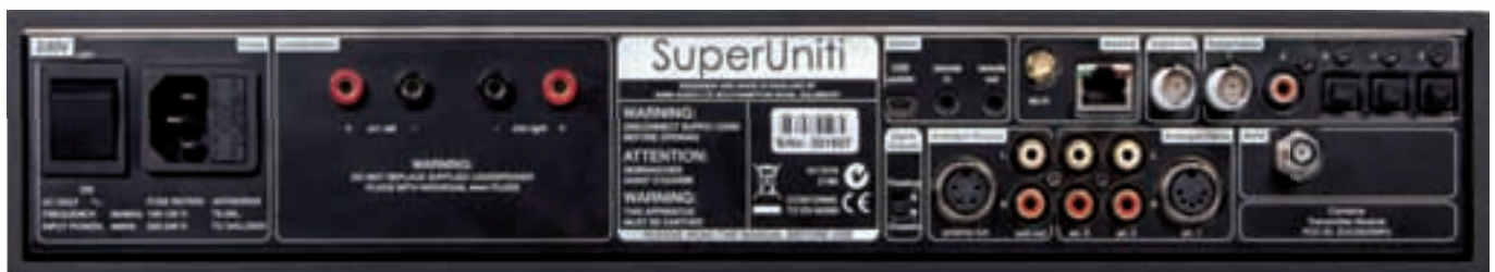
Von links nach rechts sind zu sehen: Lautsprecherterminal, ein Mini-USB-Port für Systemupdates, Wi-Fi und Ethernet-LAN zum Zugriff aufs Netzwerk sowie digitale Ein- und Ausgänge in Form von BNC, Koax und TOSLINK. Der analoge Part wird von DIN- und Cinch-Buchsen besetzt
