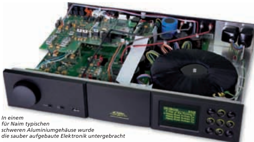
Der Übertragungsbereich der Endstufen wurde bei 30 kHz auf -6 dB begrenzt
