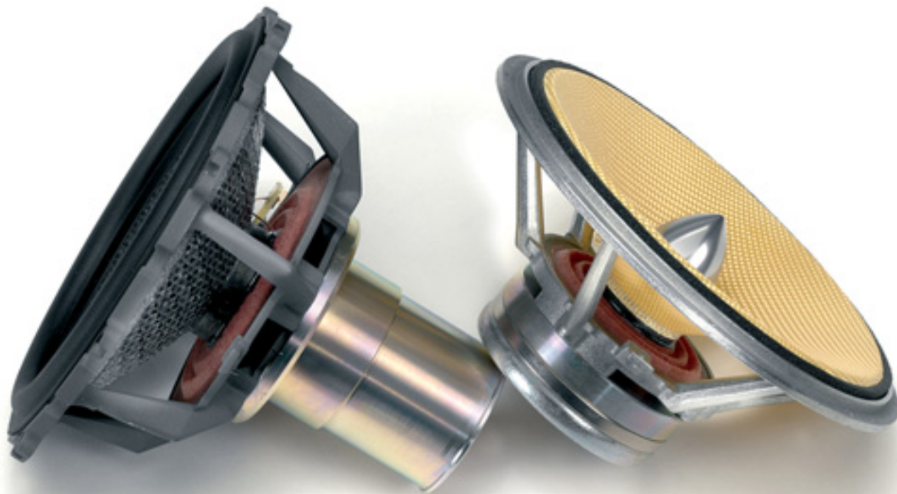
In der 804 D werkeln zwei Tieftöner mit ultrastabilen Rohacell-Sandwichmembranen und symmetrischen Doppelmagnet-Antrieben (links). B&Ws berühmter Mitteltöner nennt sich „Fixed Suspension Transducer“ und besitzt eine quasi sickenlose Kevlarmembran
