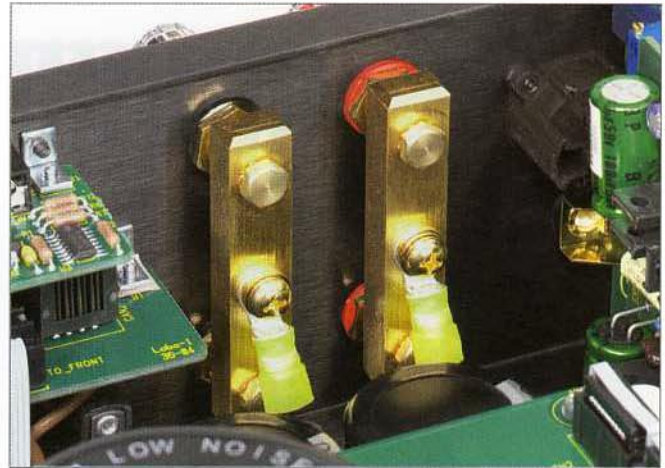
Solche Stromschienen sind angesichts der abrufbaren Leistung sinnvoll und garantieren identische Bi-Wiring-Bedingungen
