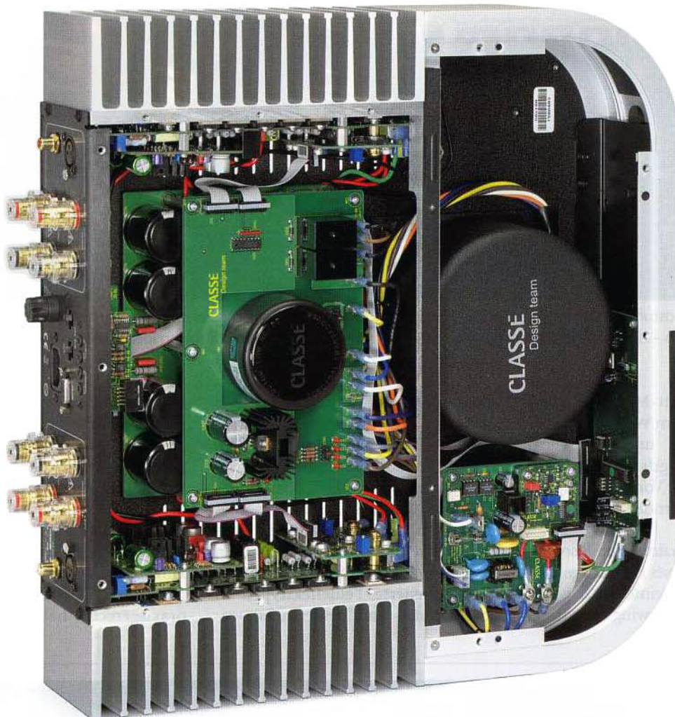
Eine Einschaltstrombegrenzung schont die Haussicherungen. Die Ringkerntrafos beliefern ein beachtliches Elko-Arsenal
