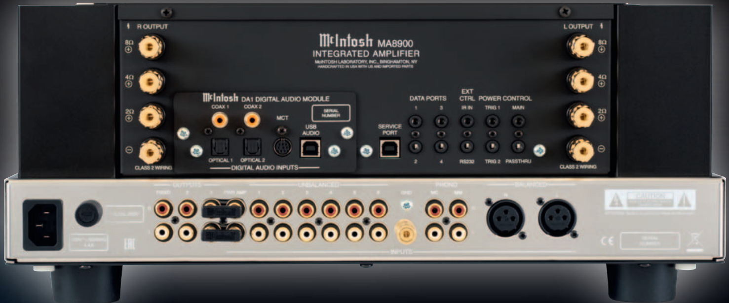
Das Digitalmodul DA1 sitzt oberhalb des Anschlussfeldes. Die Daten- und Kommunikationsbuchsen rechts oberhalb des symmetrischen Eingangs erlauben das gemeinsame Ein- und Ausschalten einer ganzen McIntosh-Anlage oder auch den Anschluss externer Infrarot-Sensoren. Der USB-Port daneben ist für Updates zuständig.
