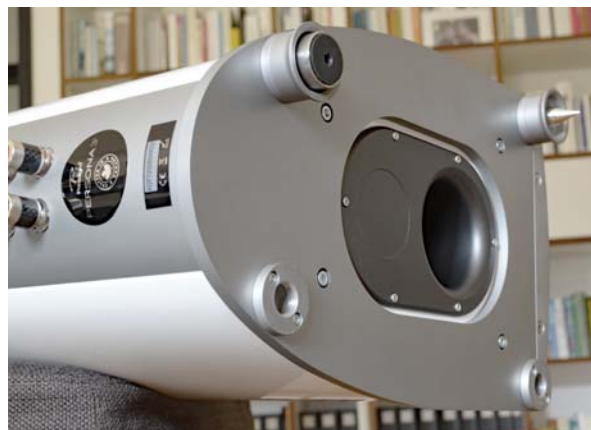
Die Paradigm Persona 3F steht auf einer soliden Metallplatte – die Bassreflexöffnung arbeitet zum Boden hin
