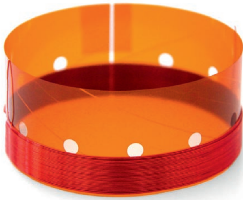
Auf einem hochtemperaturfesten Träger aus Kapton wird Dynaudios Aluminum-Schwingspule gewickelt.
