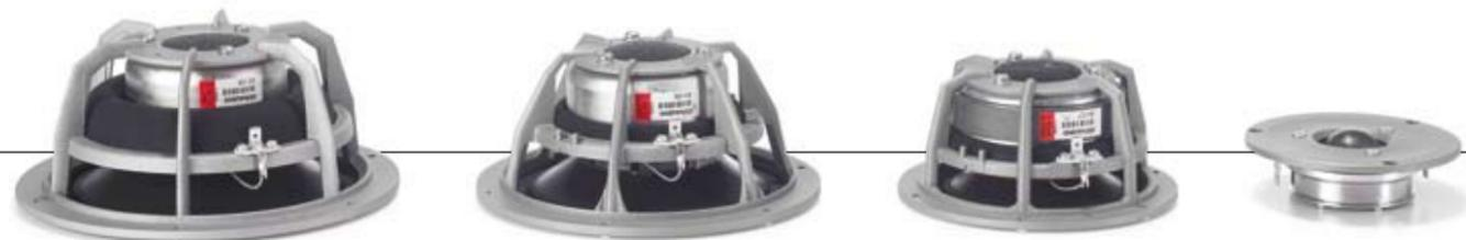
Die Konustreiber (links die Bässe, daneben der Mitteltöner) besitzen hochfeste und strömungsgünstige Körbe. Die Polkerne sind stets zum Vermeiden von Kompression durchbohrt und mit grauem Schaumstoff bedeckt. Der Hochtöner nutzt eine verfeinerte Textilmembran.
