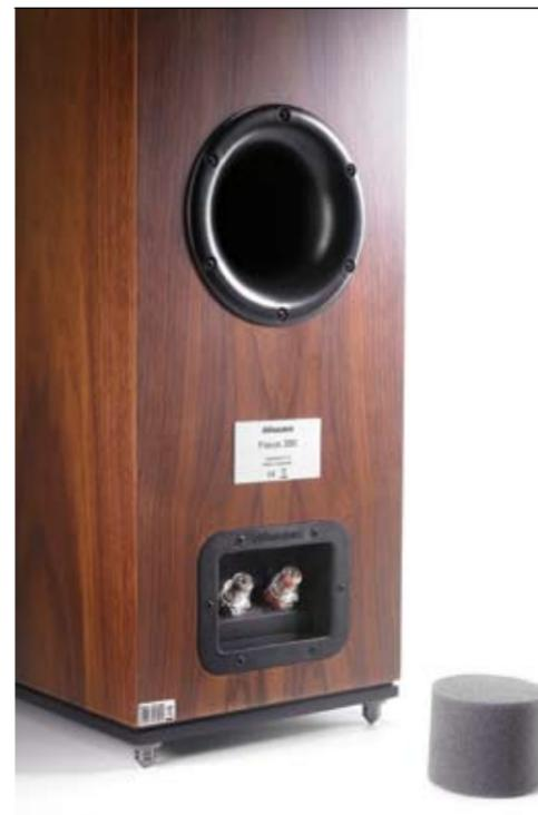
Die Reflexrohre (hier die Rückseite der Focus 380) liegen hinten und lassen sich bei Bedarf mit den beiliegenden Schaumstoff-Stopfen schließen. Der Bass wird dadurch etwas leiser.
