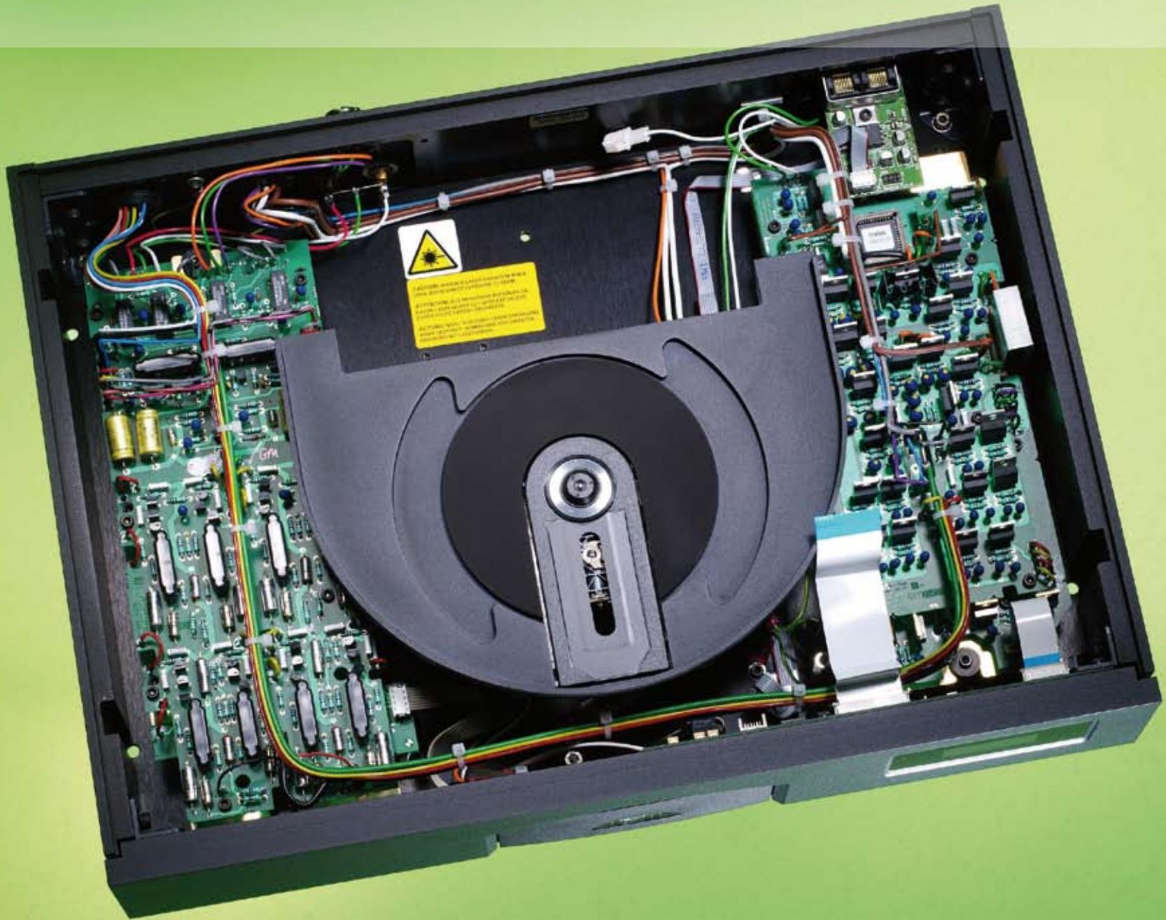
Saubere räumliche Trennung: Das obere Bild zeigt die in SMD-Technik bestückte Digitalabteilung (links) und die konventionell möblierte Analogplatine (rechts).
