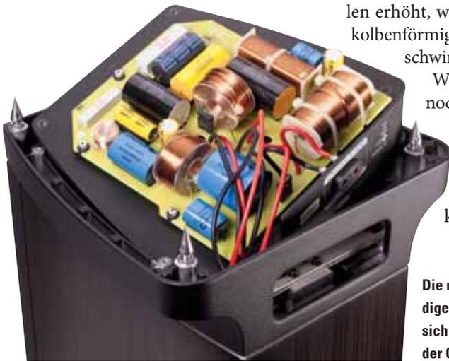
Die mit fast 20 Bauteilen aufwändige Frequenzweiche versteckt sich direkt im entkoppelten Fuß der Ovator
