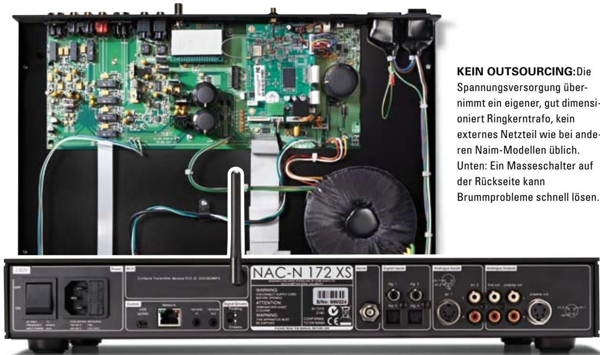
**KEIN OUTSOURCING:** Die Spannungsversorgung übernimmt ein eigener, gut dimensioniert Ringkerntrafo, kein externes Netzteil wie bei anderen Naim-Modellen üblich. Unten: Ein Masseschalter auf der Rückseite kann Brummprobleme schnell lösen.
