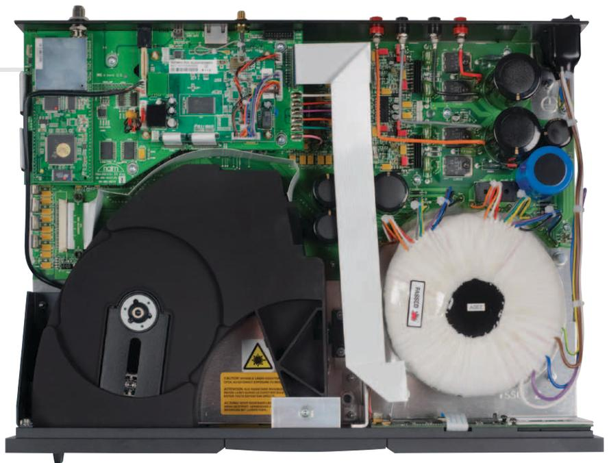
Das Netzteil nimmt, ganz wie ich es mag, einen Großteil des Innenraums ein. DAC-Board, Streaming- und Tunermodul sitzen oberhalb des Laufwerks
