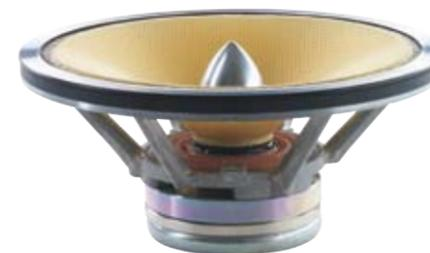
**MITTE MIT SAHNE** Für möglichst neutrale Mitten setzt B&W auf Kevlar und verzichtet auf eine Gummisicke. Ein Dämmring soll an deren Stelle Resonanzen unterdrücken.
