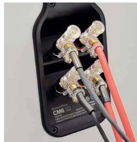
▲ Ein Bi-Wiring-Terminal am Lautsprecher – hier das der B&W CM6 S2 – ist die Voraussetzung für Bi-Wiring beziehungsweise Bi-Amping.
