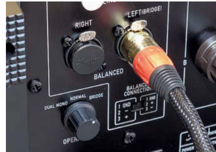
▲ Bi-Amping mit nur einer NF-Zuleitung: Der „Dual Mono“-Modus der A-47 macht's möglich.
