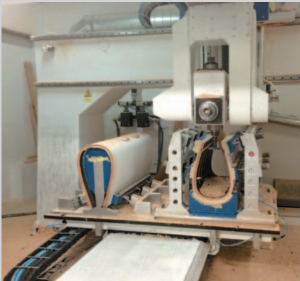
PRÄZISION: Per CNC-Fäse (linkes Bild) werden die Gehäuse für die Weiterverarbeitung in Form gebracht. Die neue Matrixkonstruktion (mittleres Bild) fällt deutlich massiver aus als beim Vorgänger. Die Gehäuse in Nussbaum (rechtes Bild) erinnern an kleine Whiskyfässer.
