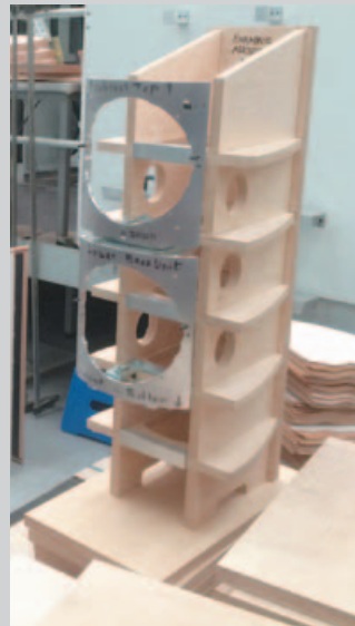
PRÄZISION: Per CNC-Fäse (linkes Bild) werden die Gehäuse für die Weiterverarbeitung in Form gebracht. Die neue Matrixkonstruktion (mittleres Bild) fällt deutlich massiver aus als beim Vorgänger. Die Gehäuse in Nussbaum (rechtes Bild) erinnern an kleine Whiskyfässer.
