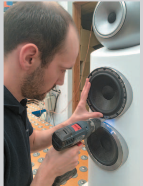
IN REIH UND GLIED: Die ebenfalls neu entwickelten Tieftöner warten geduldig auf ihren Einsatz (linkes Bild). Besteht ein Lautsprecher den Test in der Kammer nicht, wird an Ort und Stelle der entsprechende Treiber ausgetauscht.
