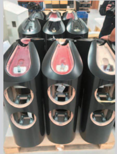
FEINER LACK: Die Gehäuse werden in mehreren Schichten lackiert und anschließend von Hand auf Hochglanz poliert. Die weiße Variante bekommt ein mattes Finish.
