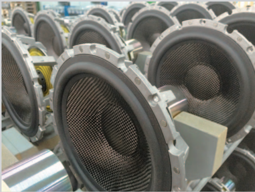
IN REIH UND GLIED: Die ebenfalls neu entwickelten Tieftöner warten geduldig auf ihren Einsatz (linkes Bild). Besteht ein Lautsprecher den Test in der Kammer nicht, wird an Ort und Stelle der entsprechende Treiber ausgetauscht.
