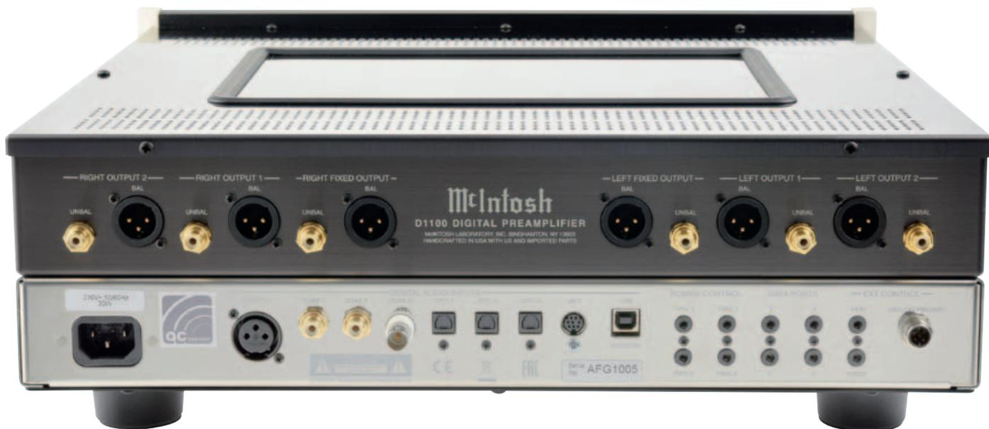
Vernetzt: Vier Datenports und vier Trigger-Anschlüsse zum Ein- und Ausschalten anderer McIntosh-Geräte ermöglichen die nahtlose Integration des D1100 auch in umfangreichere Anlagen. In Verbindung mit dem zweiteiligen Röhren-Vorverstärker C1100 ließe sich sogar eine dreiteilige Referenz-Vorstufe kreieren, bei der Analog- und Digitalteil praktisch vollständig getrennt sind.
