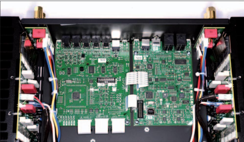
**KÜHLE RECHNER:** Oberhalb der analogen Eingangsplatine sitzt links im Bild das Digital-Modul DA1, ein ganz hervorragender DAC. Rechts davon liegt die Kommunikationseinheit zur Steuerung einer McIntosh-Anlage.
