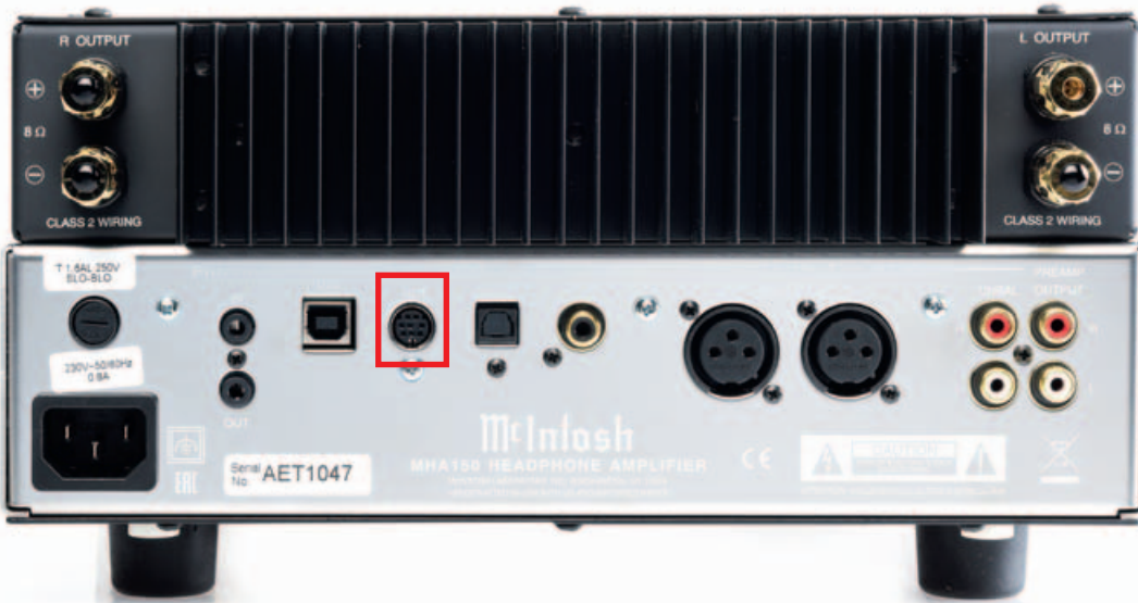
Blick von hinten: Hier ist fast alles selbsterklärend – bis auf den proprietären MCT-Anschluss (rot umrahmt). Über diese DIN-Buchse wird der McIntosh SACD/CD-Transport MCT450 angebunden, der dem MHA-150 einen verschlüsselten DSD-Stream mit voller digitaler SACD-Auflösung senden kann.
