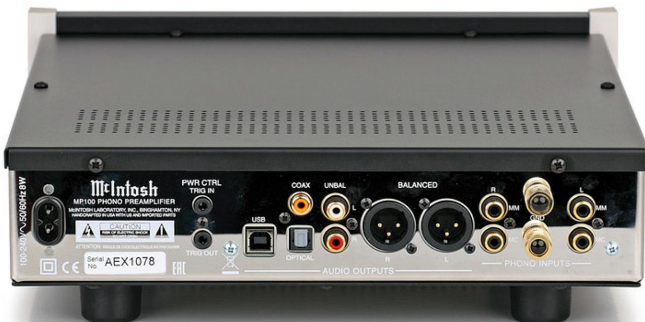
*Für pures Analogvergnügen können die Digitalausgänge des MP100 abgeschaltet werden. Analoge Cinch- und XLR-Buchsen funktionieren bei diesem Phonovorverstärker parallel.*
