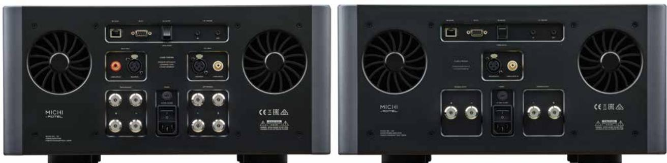
XLR- und Cinch-Verbindungen sind an Vor- und Endstufe möglich. Die LS-Klemmen sind sehr solide, die Endstufen verfügen über zwei Lüfter.
