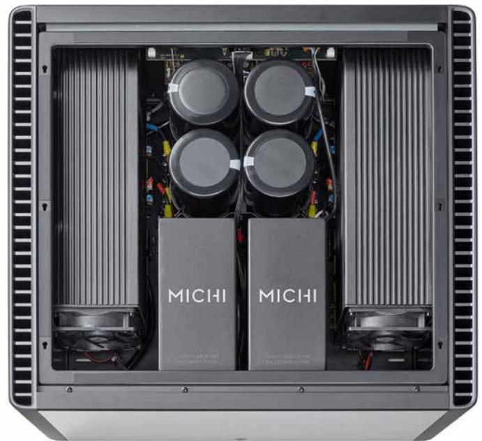
**Ein Innenaufbau wie aus dem Lehrbuch: Sowohl P5 (li.) als auch die Endstufe S5 bestechen mit extrem sauberem und servicefreundlichem Aufbau. Gut für kurze Signalwege und höchste Zuverlässigkeit.**
