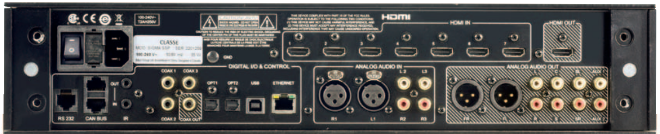
DIGITALSPEZIALIST: Auf der Rückseite erkennt man den Fokus der Sigma SSP. Digitale Eingänge überwiegen in Vielfalt und Anzahl.
