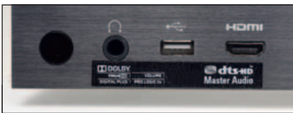
DOLBY INSIDE: Ein Aufkleber weist darauf hin, dass Dolby mit DTS-HD, Pro Logic und True HD an Bord ist.
