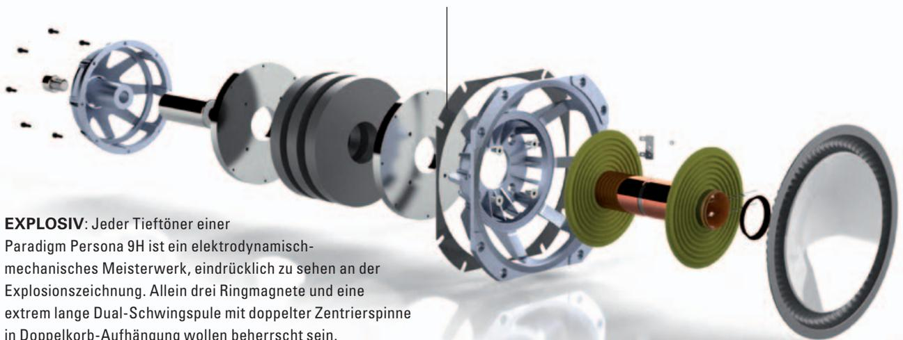
**EXPLOSIV:** Jeder Tieftöner einer Paradigm Persona 9H ist ein elektrodynamisch-mechanisches Meisterwerk, eindrücklich zu sehen an der Explosionszeichnung. Allein drei Ringmagnete und eine extrem lange Dual-Schwingspule mit doppelter Zentrierspinne in Doppelkorb-Aufhängung wollen beherrscht sein.
